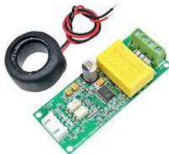
Gambar 3. Sensor Arus dan Tegangan PZEM-004T
