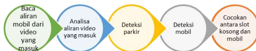
Gambar 1. Kerangka kerja untuk mendeteksi tempat parkir yang tersedia di Smart City
